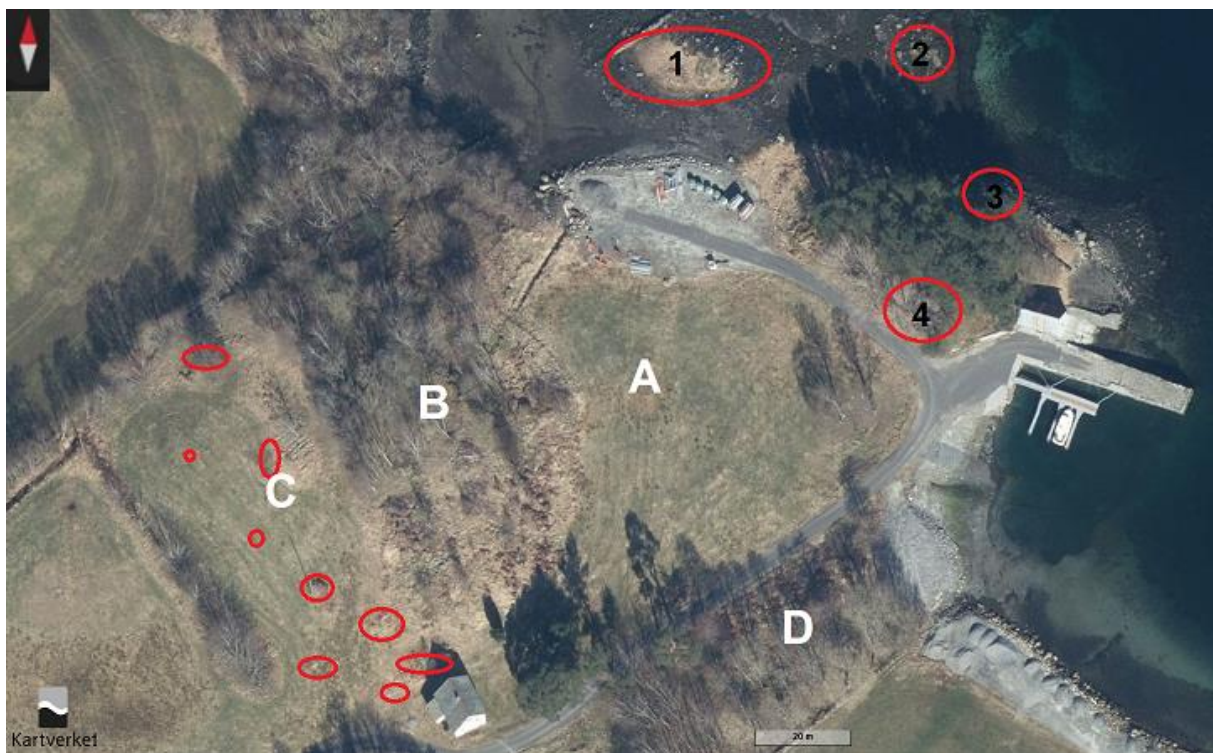
Figur 15 Feltobservasjoner på eiendommen. Det er fjellblotning (rød markering) i fjæresonen og på platå ved kote 17 øverst i planarealet.
